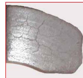
**ASPECT** Présence de fissures sur la surface des plaquettes.
