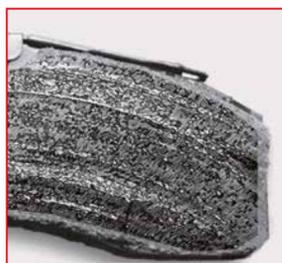
**ASPECTO** Material de fricción de las pastillas contaminado.
