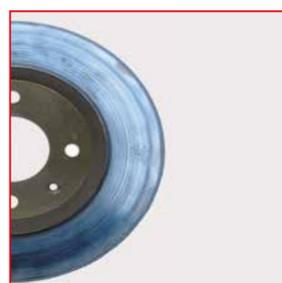
**ASPECTO** Azuleo del disco que indican un cambio físico debido al sobrecalentamiento.
