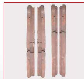
**ERSCHEINUNGSBILD** An der selben Achse montierte Bremsbeläge weisen einen unterschiedlichen Verschleiß auf.
